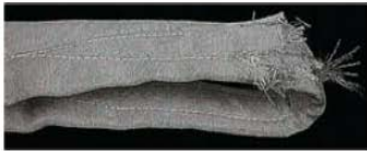
Halka takviyesi hasarlanmış.
