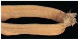
Halka kısmında hasarlanma var.
