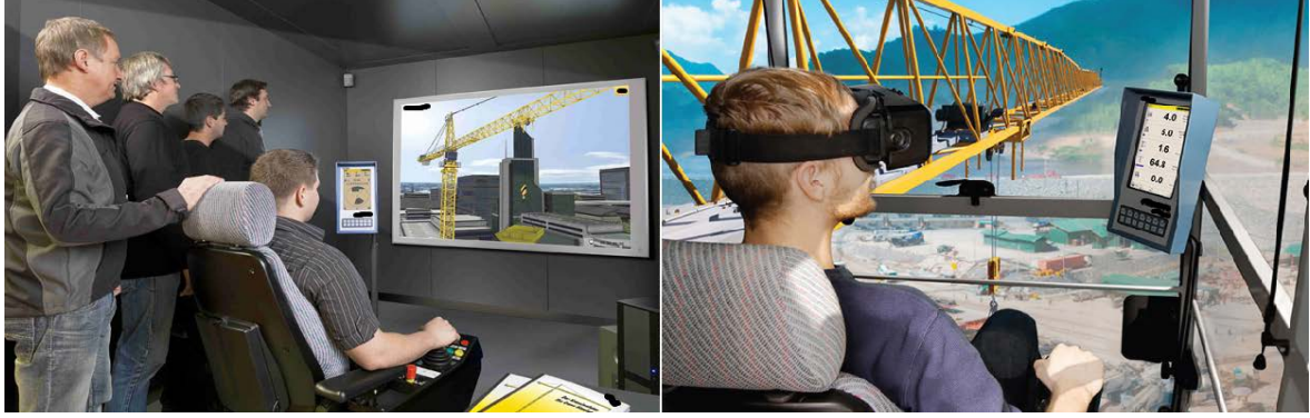
Şekil 37. Kule vinç eğitimlerinde simülasyon ve sanal gerçeklik uygulamaları
