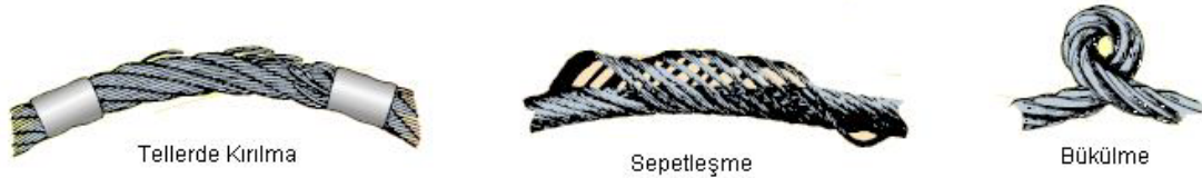
Şekil 22. Halatlarda meydana gelen bazı hasarlar
