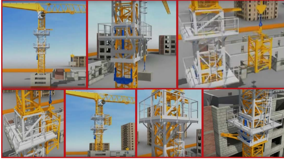
Şekil 49. Kule vinç gövdesine modül eklenmesi ve vinç-bina bağlantısı
