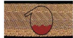
Asitler / bazlar nedeniyle hasarlanmış.
