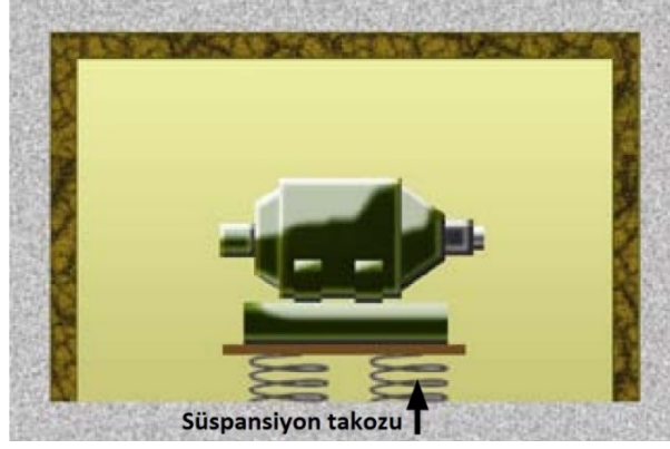
Şekil 4.15 Gürültülü ekipmanın örtülmesi
