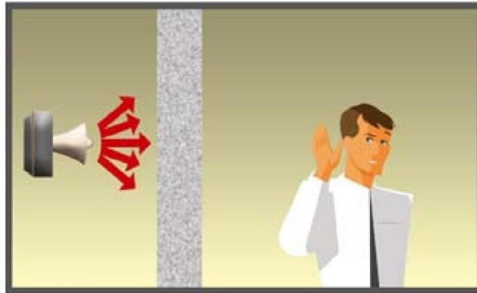
Şekil 4.13 Gürültülü ekipmanı duvarlar kullanarak yalıtın
