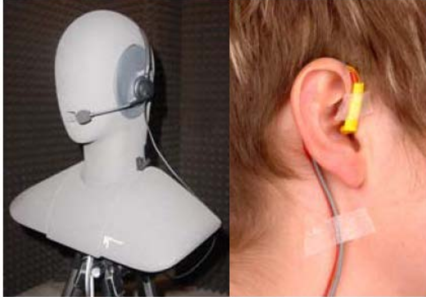
Şekil 2.5 HATS ve MIRE yöntemleri kullanılarak kulakta gürültü ölçümleri Sol: Baş ve gövde simülatörü (HATS) (Kaynak Baş Akustiği GmbH – Almanya) Sağ: MIRE
