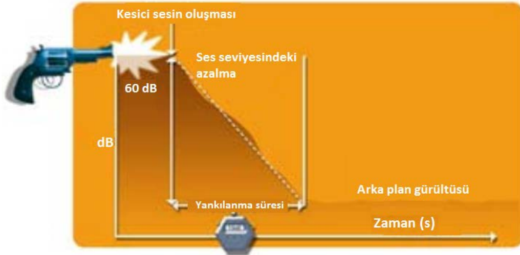
Şekil 3.4 Ortamın akustik etkileri; kesici bir ses kullanılarak bu sesin, yüzey yansımalarının neden olduğu sönüm süresinin ölçülmesiyle belirlenebilir. “Yankılanma süresi” ( T_r ), ses seviyesinde 60 dB azalma gerçekleşmesi için gereken süredir.
