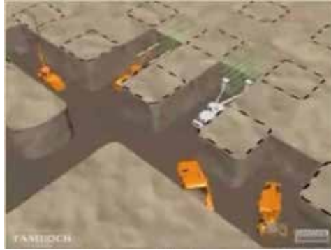
Şekil 2.2. Yeraltı metotlarından oda topuk metodu [6]
