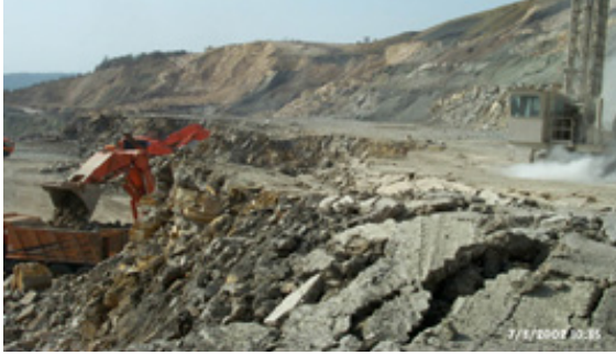
Fotoğraf 17: Delik delme işleminde toz oluşumu
