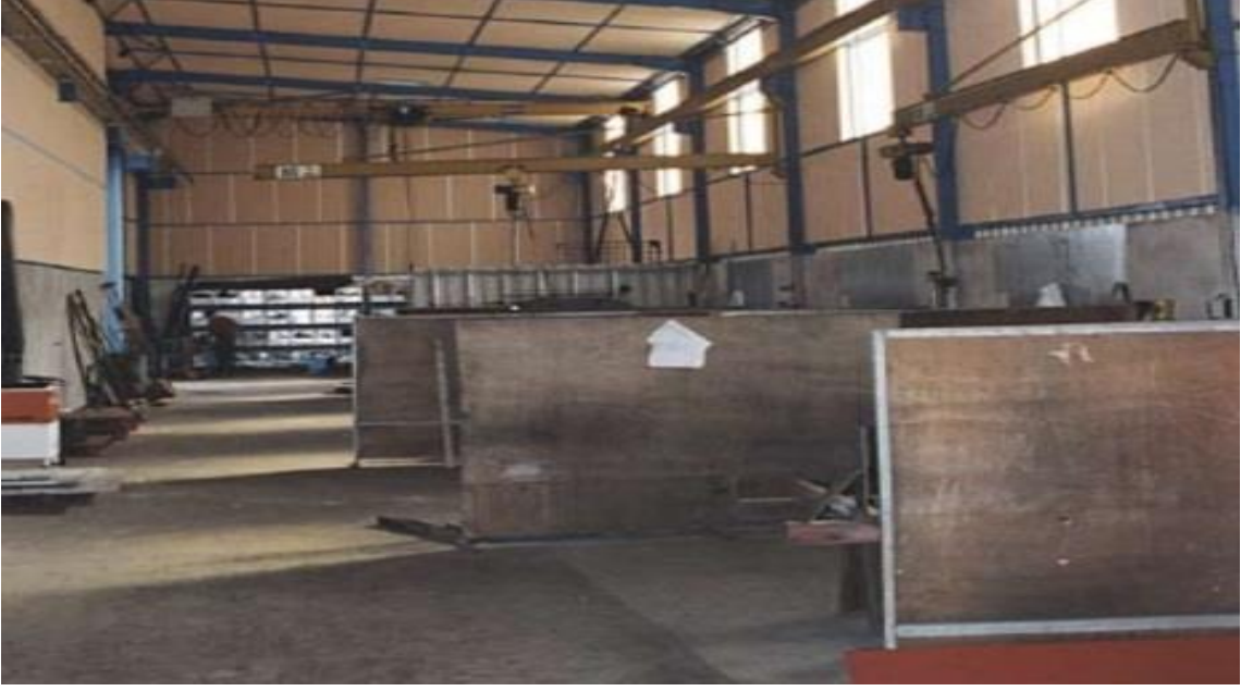
Şekil 2.20 Metal işleri– Paravan Uygulaması
