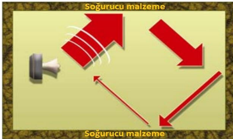
Şekil 2.2 Soğurucu malzemenin etkisi
