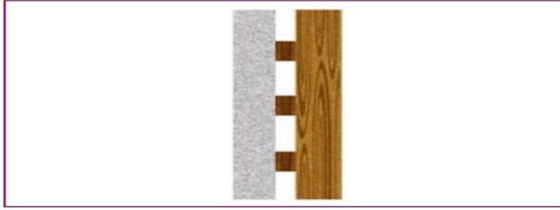
Şekil 2.15 "Diyafraamlar", alta çıtalar yerleştirilerek duvara sabitlenen ahşap levhalardır. Alçak frekanslı sesleri azaltırlar.
