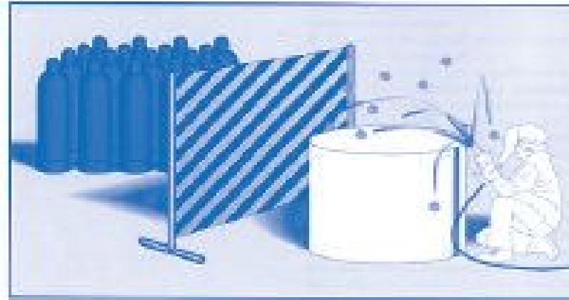
Resim 11.Sıçrayan Kıvılcımlara sebep olan bir çalışmada perdeleme örneği
