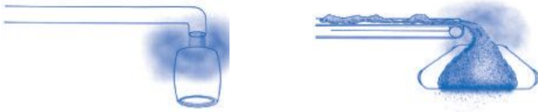
Resim 1. Taşınım ve dolum işleminde hava/toz karışımına bir örnek
