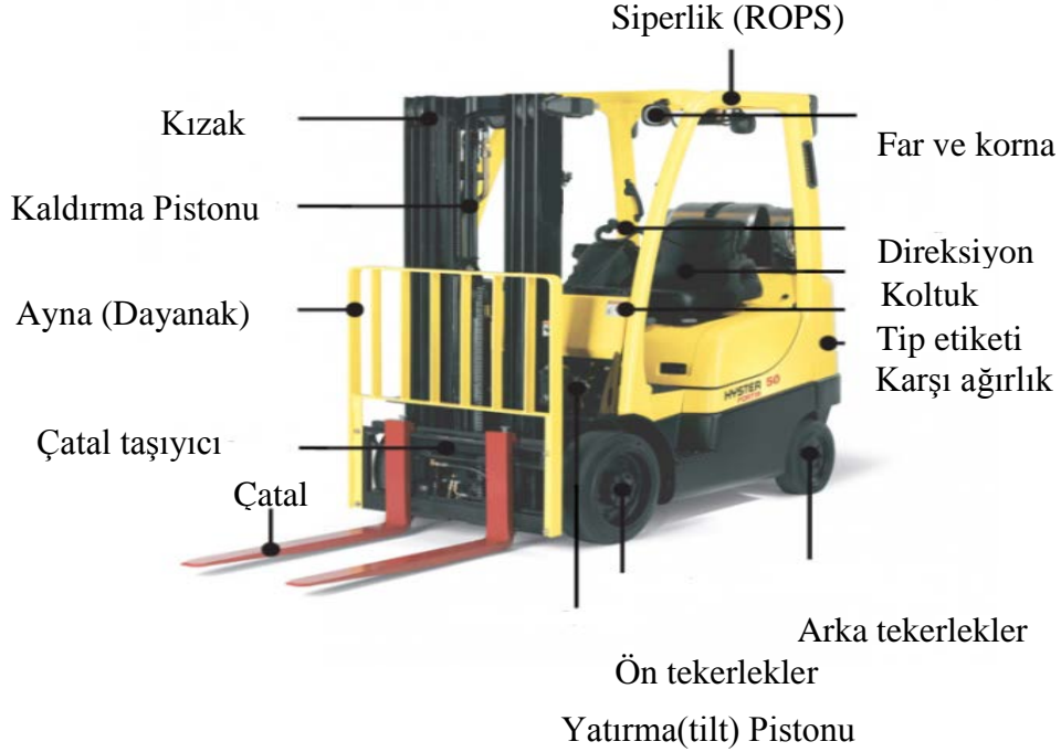
Şekil 3.1. Forklift Parçaları
