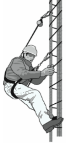
Şekil 3.9. Çalışma konumlama sistemi [14]
