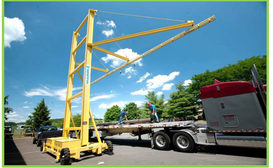
Şekil 5.5. Araç üzerinde düşmeye karşı koruma [32]
