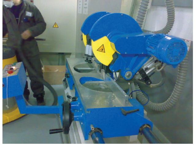
Koruyucusu olmayan ve olan daire testereler
