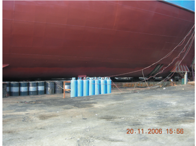
Gaz Tüplerin Uygunsuz Şekilde Depolanması ve Taşınması
