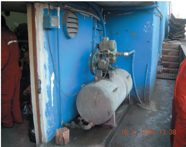
İşyeri ortamında önlem alınmadan bulundurulmuş kompresörler
