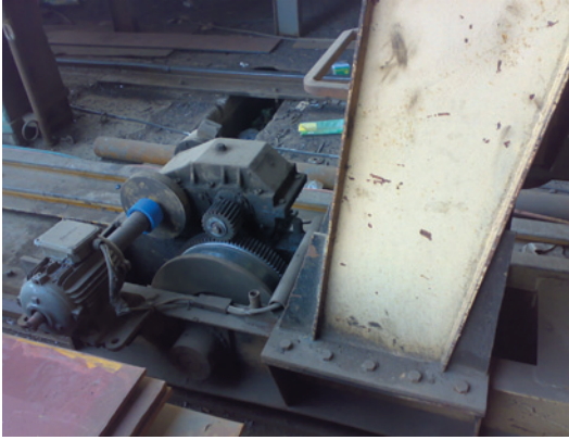
Koruyucusu Olmayan ve Olan Motorlar
