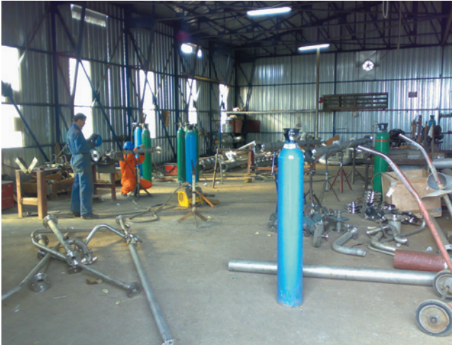
Gaz Tüplerin Uygunsuz Şekilde Depolanması ve Taşınması
