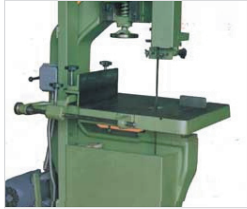
Koruyucusu Olmayan ve Olan Şerit Testereler
