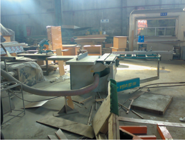
Koruyucusu olmayan ve olan daire testereler
