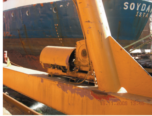
Koruyucusu Olmayan ve Olan Motorlar
