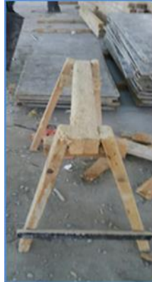
Şekil 3-8. Seyyar İskelelerde Yapılan Çalışmalarda Düşme Riski – Uygun Seyyar İş İskelesi
