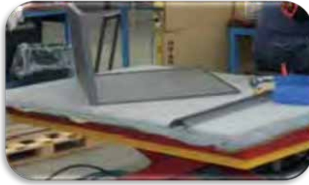
Şekil 3.14 Yüksekliği ayarlanabilir çalışma tezgahı
