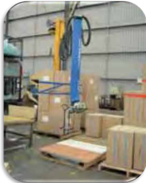
Şekil 3.13 Vakumlu kaldırıcının tamamlanan ürünün yüklenmesinde kullanımı
