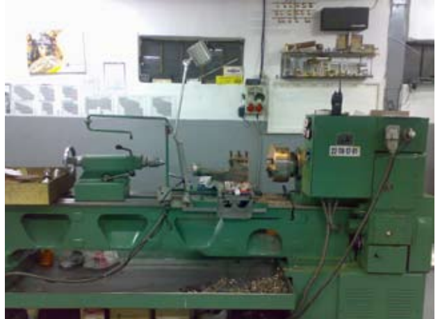
Siperi ve paravanı olan ve olmayan torna tezgahı
