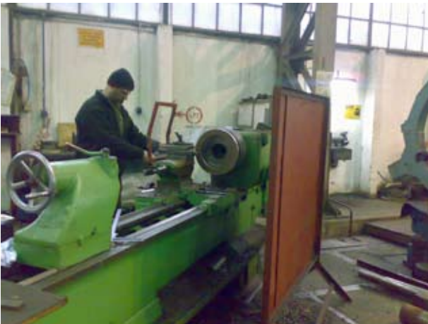
Siperi ve paravanı olan ve olmayan torna tezgahı
