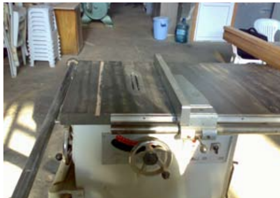
Koruyucusu ve toz emişi olmayan daire testere tezgahı
