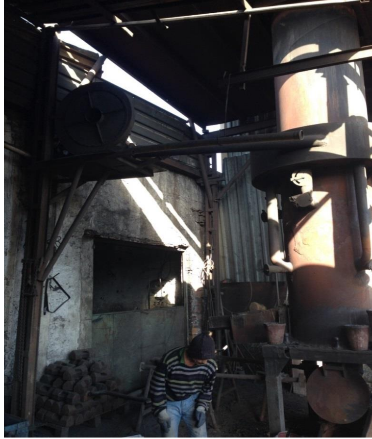
Şekil 26. Kupol Ocak ve Fan Örneği
