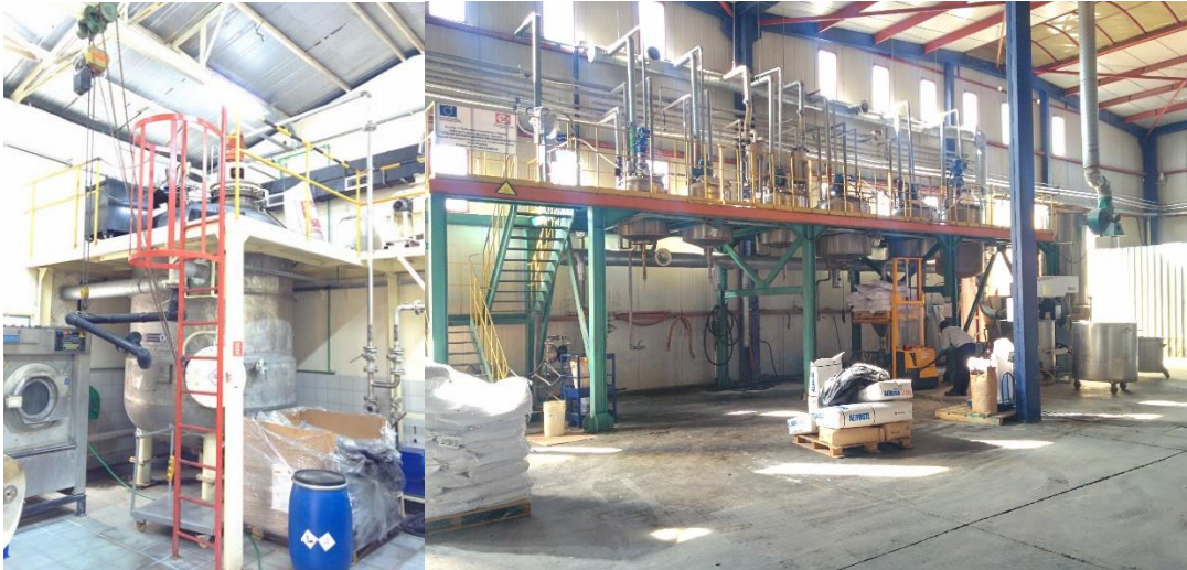
Resim 2.4. Toz dolum ünitesindeki yüksek platformlar
