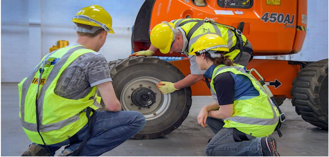
Resim 1.4. YSİP lastik basıncı kontrolü
