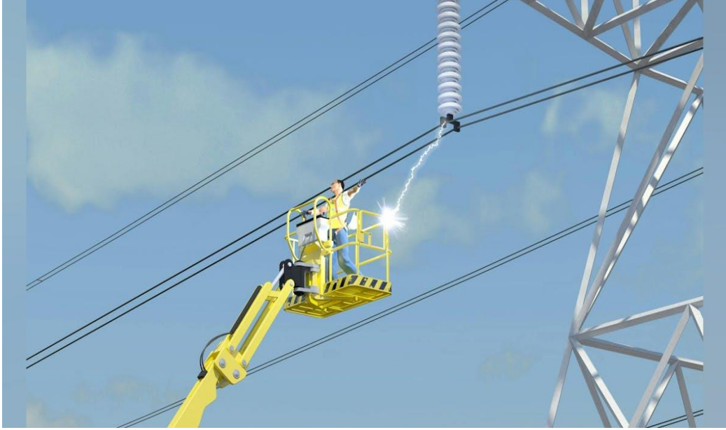
Resim.1.2.YSİP kullanımında elektrik tehlikesi
