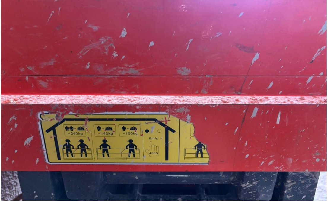
Resim 3.1. Yk ve kiři sınırını gsteren uygunsuz etiket
