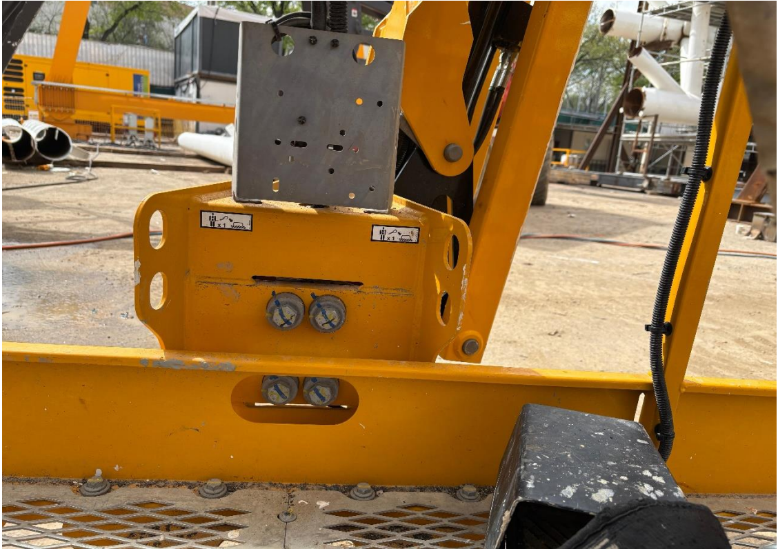
Resim 3.2. Bağlantı halatı takılması için belirlenmiş bağlantı noktası
