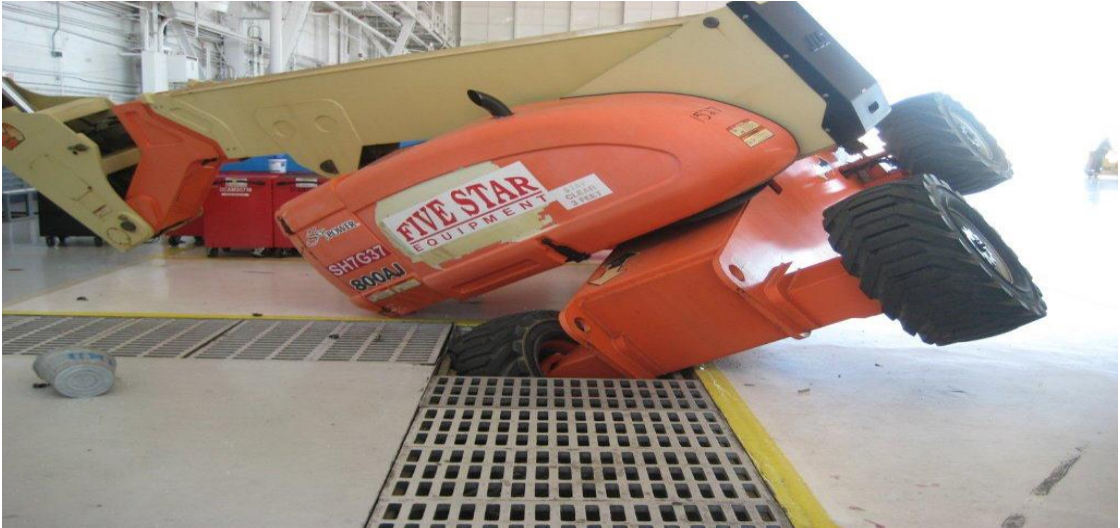
Resim 1.1. Zemin koşulları nedeniyle devrilen YSİP
