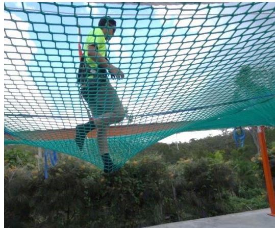
Şekil 13: Yük sonucu esneme
