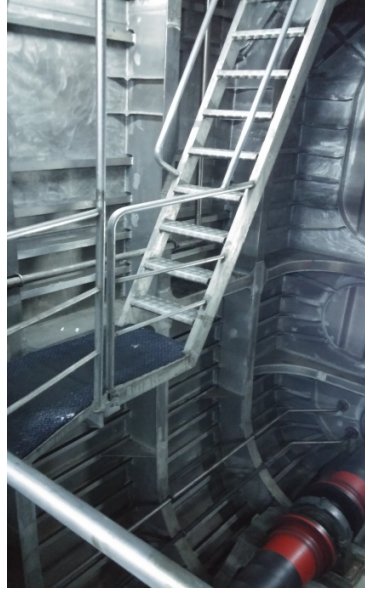
řekil 2.8. alıřan Milin zerinde Dik Bir Merdiven
