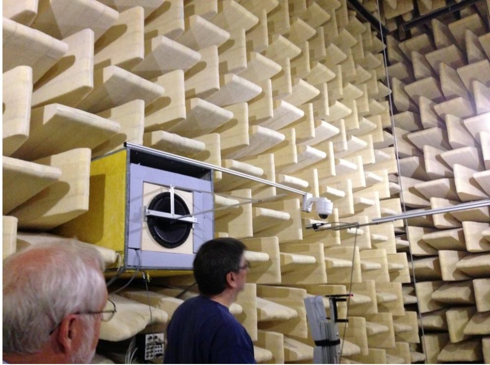
Şekil 3.9. Sessiz Oda ve Kalibrasyon Düzenegi Örneği[26]
