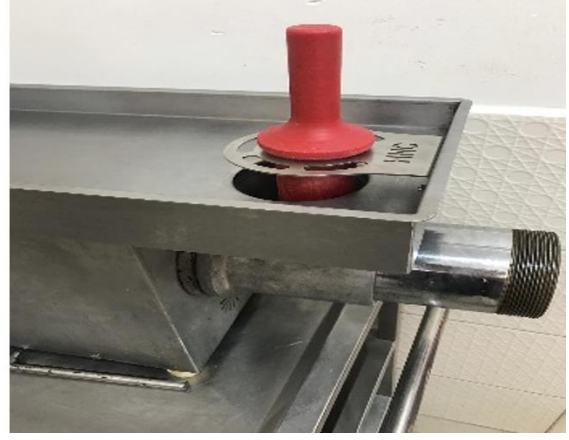
Şekil 3.6 - Yemekhanedeki Kıyma Makinesinin Koruyucusunun Takılması
