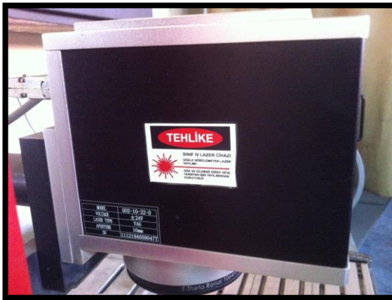
Resim 4.3. Lazer cihazı üstündeki güvenlik işaretleri
