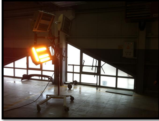
Resim 4.8. Kızıl ötesi kurutma yapan cihazın çalışırken görünümü
