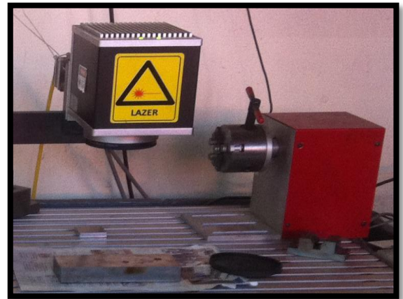
Resim 4.3. Lazer cihazı üstündeki güvenlik işaretleri
