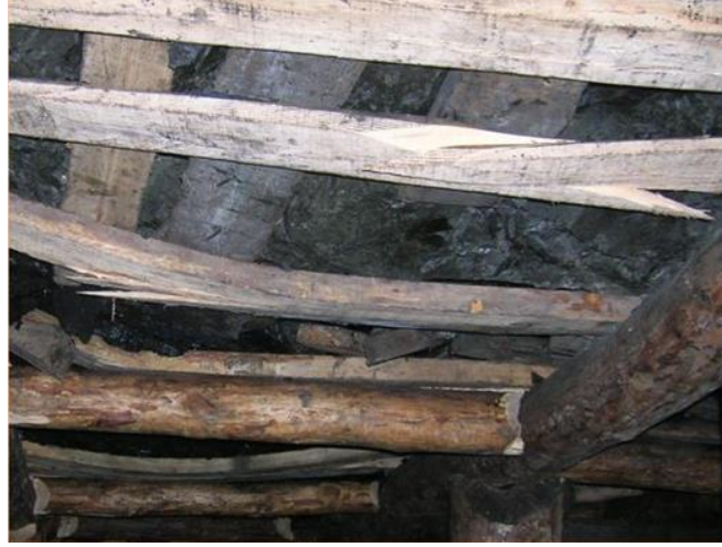
Resim 2.2. Eksik Kama Sonucunda Deformasyona Uğramış Tavan Tahkimatı [22]
