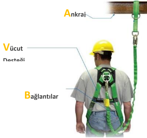
Şekil 3.17. Kişisel düşmeyi durdurucu sistemin temel bileşenleri [22]
