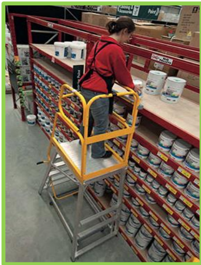
Şekil 5.2. Platformlu merdivende çalışma [10]
