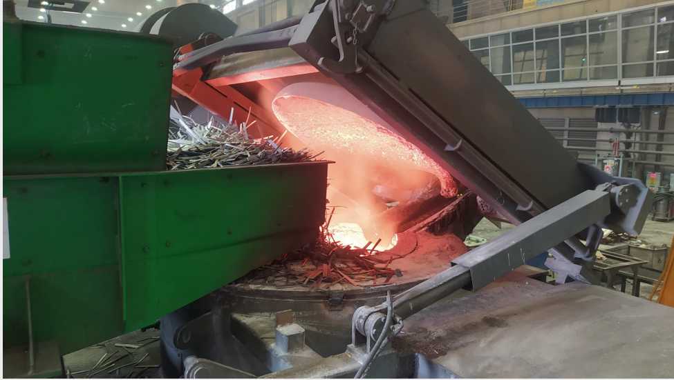
Resim 1. Kocaeli – Dilovası’nda bulunan bir döküm fabrikasında atıl metallerin eritilme prosesinden bir fotoğraf.
