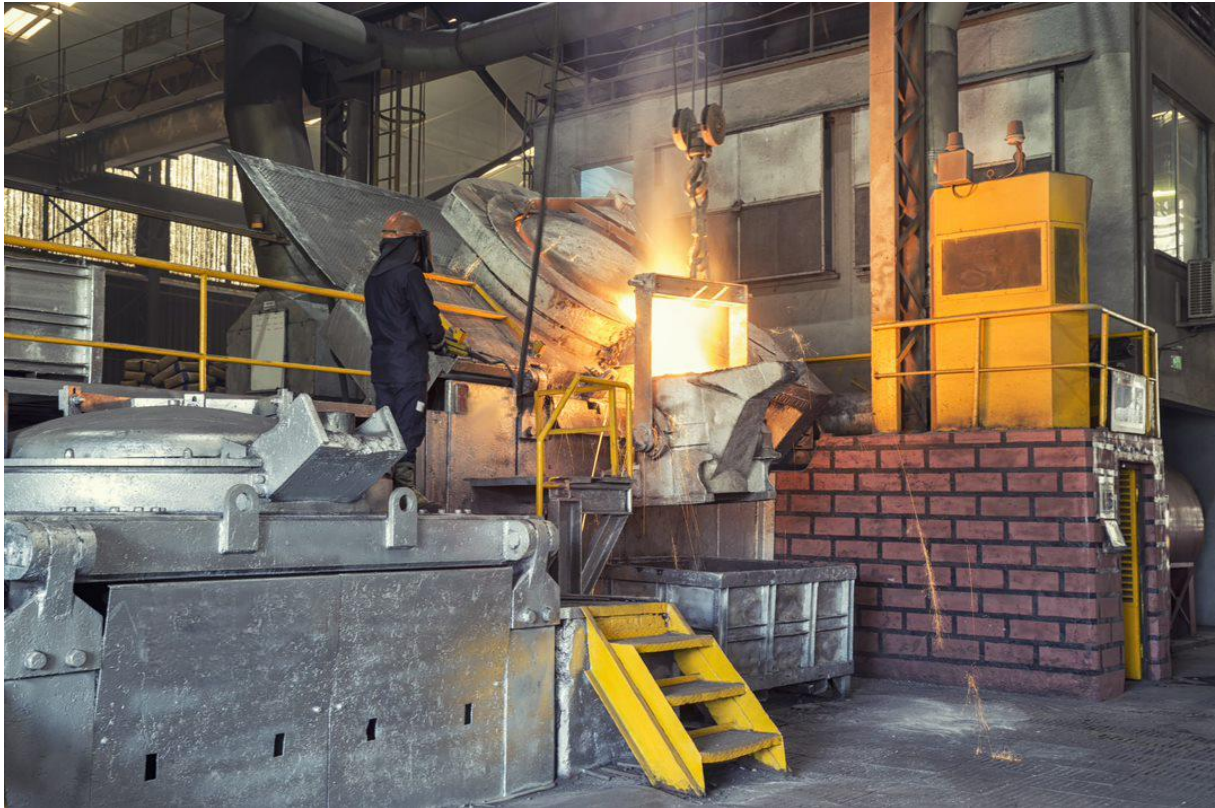
Şekil 32: Ergitme / Döküm İşlemi
