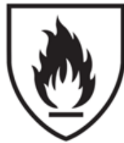
Şekil 23: Sıcağa karşı koruyucu eldiven TS EN 407 piktogramı (TS EN 407 Termal risklere (ısı ve / veya ateş) karşı koruyucu eldivenler ve diğer el koruyucu ekipmanları, 2020)
